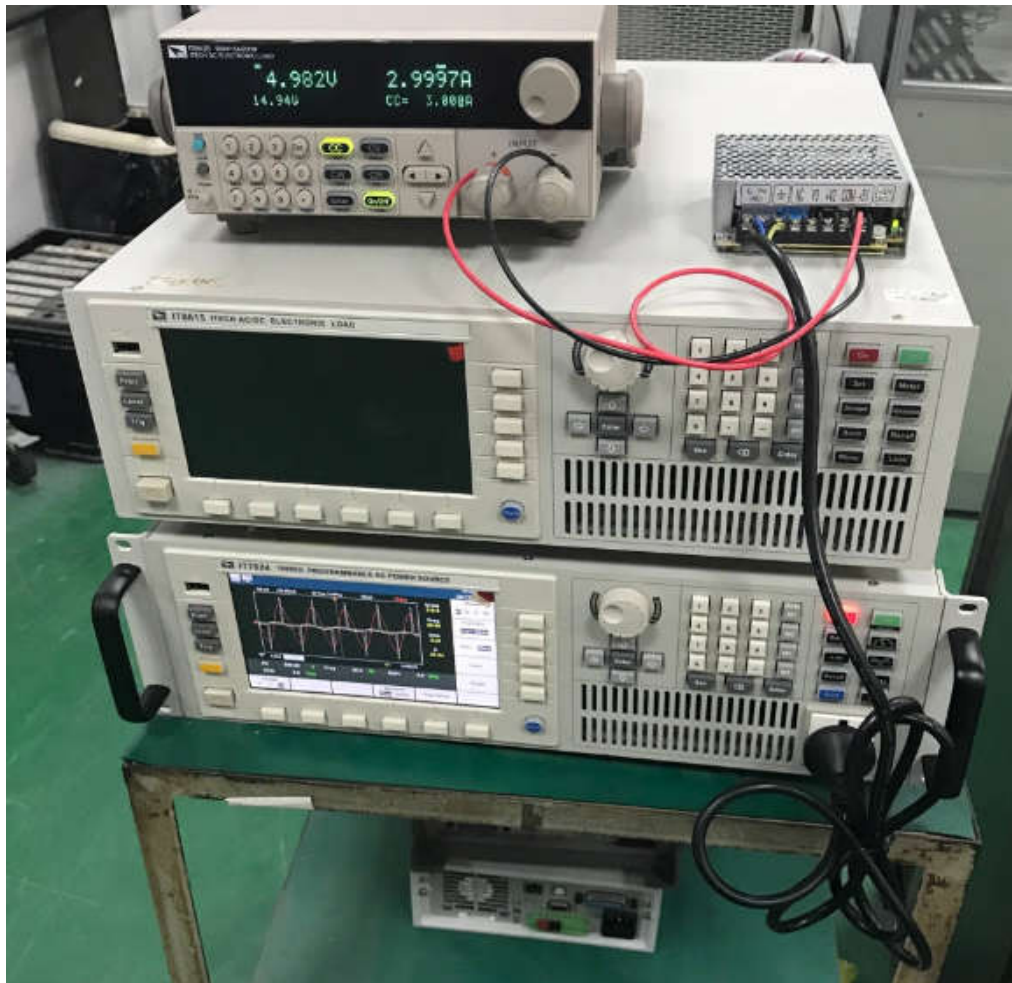
图 2 IT7600 带载测试图
