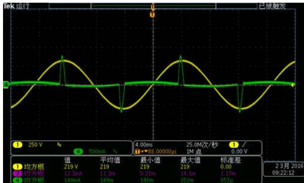
图 1 高峰值电流波形图
