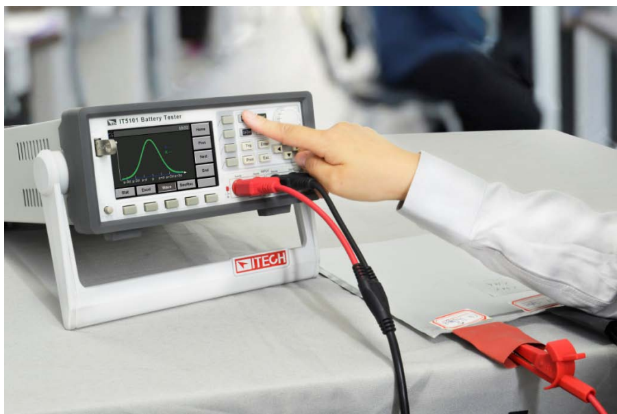
图五、IT5101 利用统计功能测量 ipad 锂电池的电压和内阻
