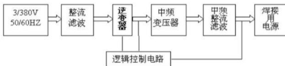
图 1：焊机电源原理拓扑图
